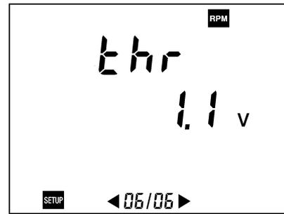
Figura 49: Visualización del parámetro relativo a la tensión de umbral del detector taquimétrico.
