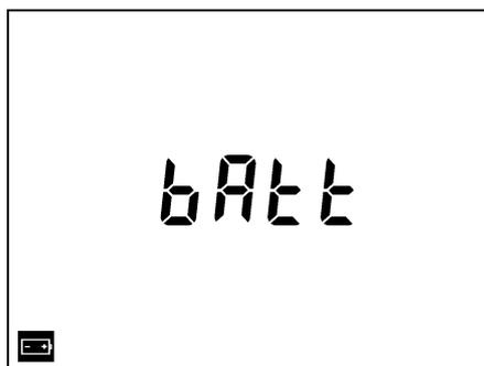
Figura 5: Indicación de batería débil que necesita sustitución.
