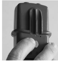
Sostenga el medidor de campos eléctricos manteniendo un contacto directo entre uno de sus dedos con la zona correspondiente situada en la cara trasera del aparato.
