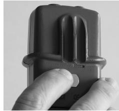
Reggete il rivelatore di campi elettrici e con un vostro dito mantenete un contatto diretto con la zona appropriata situata sul lato posteriore dell'apparecchio.
