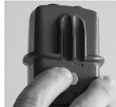
Tenez le testeur de champs électriques en maintenant un contact direct de l'un de vos doigts avec la zone appropriée située sur la face arrière de l'appareil.
