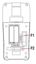
Para que el instrumento siga siendo seguro, sustituya el fusible defectuoso únicamente por un fusible de características estrictamente idénticas:
