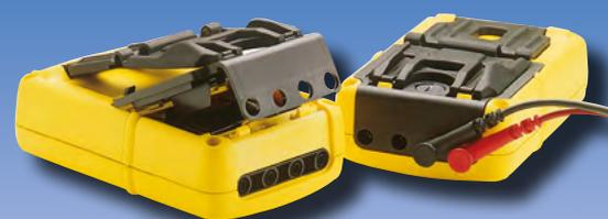
Es obligatorio desconectar los cables antes de abrir la tapa de acceso a la pila y a los fusibles. La tapa se abre fácilmente dando 1/4 de vuelta al tornillo con la ayuda de una moneda o de un destornillador.
