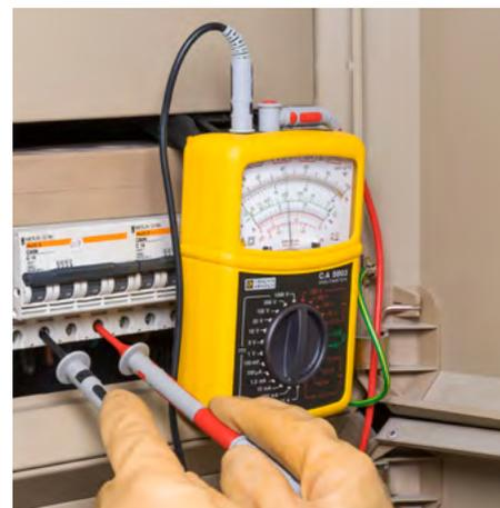
▲ La lengüeta articulada garantiza el mantenimiento del C.A. 5003 en posición vertical para una lectura en la proximidad del punto de control.
