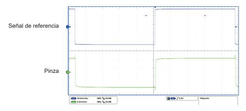
Respuesta al impulso a ± 2 Apico a la frecuencia de 1 kHz en el rango 100 mV/A
