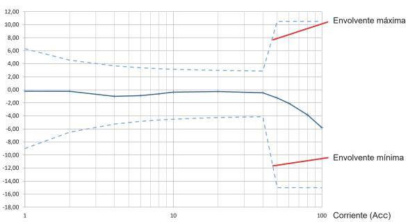
Curva típica del error en amplitud para una corriente CA rango 10 mV/A
