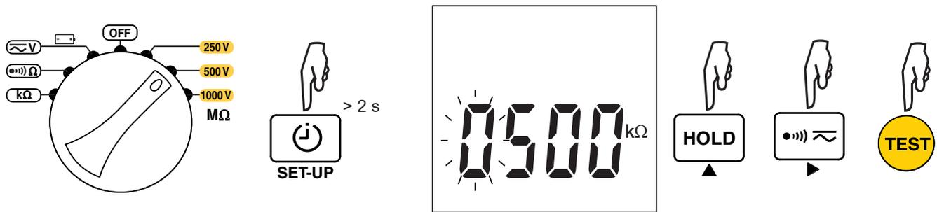
Verwenden Sie die Taste ▲, um die Ziffer einzustellen, und die Taste ►, um zur nächsten Ziffer zu gelangen. Wenn die 4 Ziffern eingestellt sind, wählen Sie die Einheit aus. Bestätigen Sie dies durch Drücken der Taste **TEST**.
