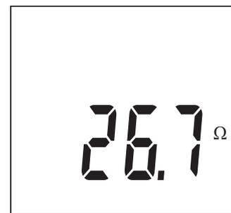
Um sicherzustellen, dass keine Spannung anliegt, führen Sie vor der Durchgangsmessung eine Spannungsmessung durch. Andernfalls zeigt das Gerät das Vorhandensein einer Spannung an.
