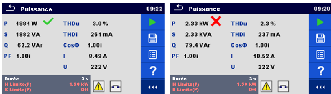
Figure 5.44 : Exemples de résultats de mesure de Puissance
