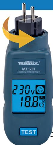
Un controlador 3 en 1 que se conecta a cualquier toma de corriente de una instalación eléctrica TT para comprobar la instalación eléctrica
