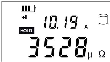
Allacciare le pinze sul primo oggetto da misurare. La misura si avvia automaticamente. Rimuovere le pinze, la misura si blocca e il risultato si visualizza. Allacciare le pinze sul secondo oggetto da misurare. La misura si riavvia automaticamente. E così via. Alla fine dell'ultima misura, premere di nuovo il bottone START/STOP.
