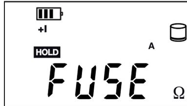
Se si applica una tensione superiore a 20 V fra i morsetti C1 e C2, il fusibile posto sulla faccia anteriore dell'apparecchio è distrutto e occorre sostituirlo (vedasi § 8.2).
