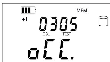
Se l'ubicazione scelta è già occupata, l'apparecchio lo segnala. Ma è possibile sostituirla con la nuova misura.
