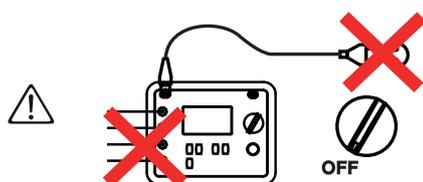
Utilizzare un panno soffice, leggermente imbevuto d'acqua saponata. Sciacquare con un panno umido e asciugare rapidamente con un panno asciutto oppure aria compressa. Non utilizzare alcol, solventi o idrocarburi.
