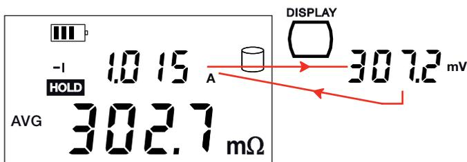
Per visualizzare la tensione ai morsetti della resistenza anziché la corrente di misura, premere il tasto DISPLAY.
