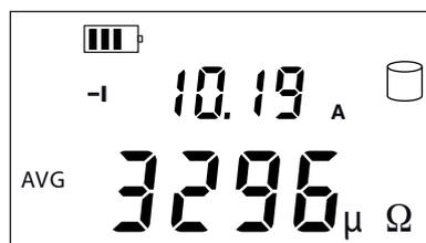
Invertire il senso della corrente premendo il tasto ±I, e l'apparecchio visualizza la media:
