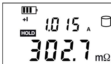
Se la misura è bloccata dal disinserimento di una pinza, basta inserirle nuovamente su un nuovo oggetto per avviare una nuova misura, senza premere il tasto START/STOP.
