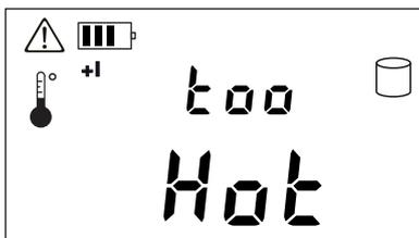
Se una misura sul calibro 10 A dura vari minuti, si produce un surriscaldamento interno che impedisce qualsiasi misura. Occorre lasciare raffreddare l'apparecchio per procedere alle misure.
