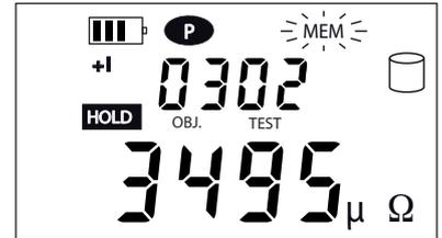
Ad ogni nuova misura, il numero del test viene incrementato e la misura viene registrata.
