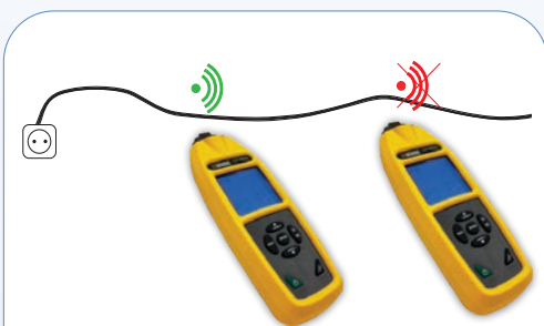
Identifique la tensión de red y busque un corte en el circuito
