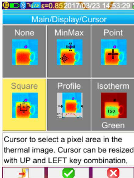
Standardmäßig ist kein Messcursor ausgewählt (Element in Hauptmenü/ Anzeige/Cursor auswählen), und die Kamera erzeugt nur IR-Bilder.
