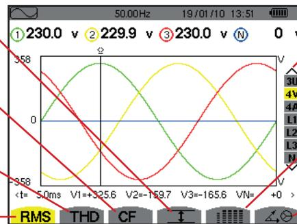
Auswahl der Anzeigefilter. Verwenden Sie die Tasten ▲ oder ▼ zur Auswahl der Anzeige.
