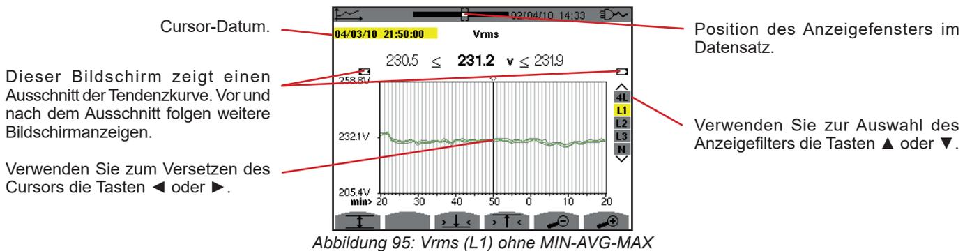
In allen drei Phasen (L1, L2 und L3) zeichnet das Gerät beim Aufzeichnen eines Werts (Speicherdauer 1 Sekunde) auch den Halbperioden-RMS-Mindestwert für eine Sekunde und den Halbperioden-RMS-Höchstwert für eine Sekunde auf. Diese drei Kurven sind in der obigen Abbildung dargestellt.
