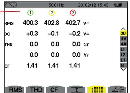
Abbildung 78: Bildschirm zur gleichzeitigen Anzeige bei 3U
