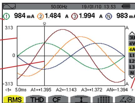
Momentanwerte der Signale an der Schnittstelle zwischen dem Cursor und den Kurven.
