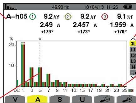
Anzeige der 3 Phasen 3L oder von L1, L2, L3 und N oder des Expertenmodus (nur Anschlussart Dreiphasig - siehe §6.5) . Drücken Sie zur Auswahl der Anzeige die Tasten  $\blacktriangle$  oder  $\blacktriangledown$  .
