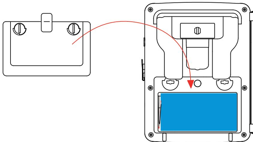
**Achtung:** Wenn der Akkuanschluss unterbrochen wurde - und selbst wenn kein neuer Akku eingelegt wurde - muss der Akku auf jeden Fall komplett geladen werden, damit das Gerät den Ladezustand des Akkus erfassen kann (diese Information geht verloren, wenn der Akkuanschluss unterbrochen wird).
