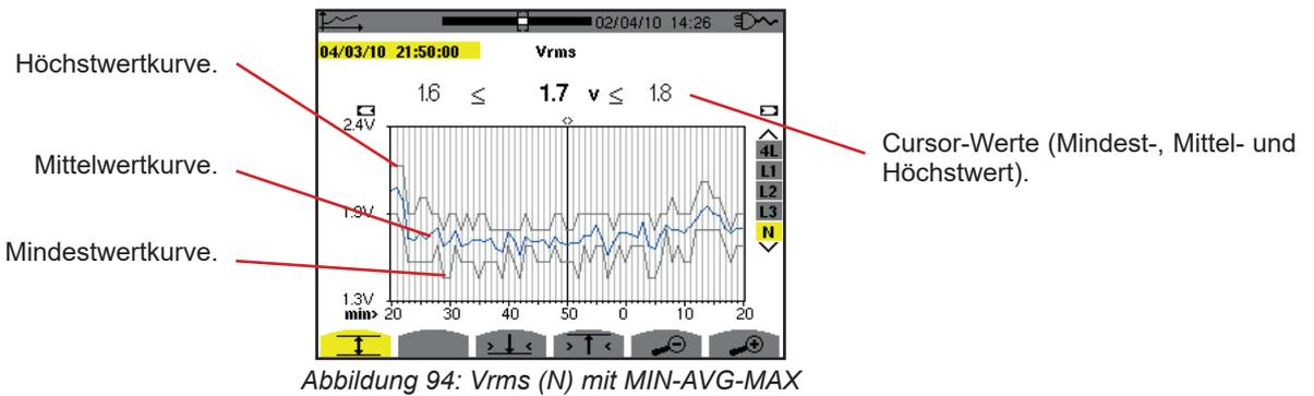
Die Anzeigeperiode dieser Kurve ist eine Minute. Jeder Punkt der Kurve entspricht dem rechnerischen Mittelwert von 60 im Sekundenrhythmus gespeicherten Werten. Jeder Punkt der Höchstwertkurve entspricht dem Höchstwert der 60 im Sekundenrhythmus gespeicherten Werte. Jeder Punkt der Mindestwertkurve entspricht dem Mindestwert der 60 im Sekundenrhythmus gespeicherten Werte
