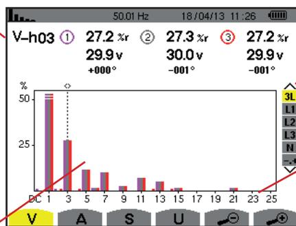
Anzeige der 3 Phasen 3L oder von L1, L2, L3 und N oder des Expertenmodus (nur Anschlussart Dreiphasig - siehe §6.5). Drücken Sie zur Auswahl der Anzeige die Tasten ▲ oder ▼.
