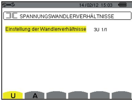
Abbildung 26: Bildschirm Spannungsverhältnisse im Menü Stromwandler und Übersetzungsverhältnisse – Fall einer Anordnung **ohne** Neutralleiter
