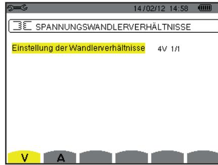
Abbildung 27: Bildschirm Spannungsverhältnisse im Menü Stromwandler und Übersetzungsverhältnisse – Fall einer Anordnung **mit** Neutralleiter
