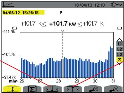
Um den Cursor auf den Maximalwert des Leistungsaufzeichnung zu positionieren.
