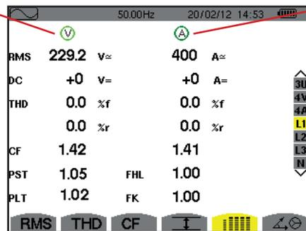
Werte RMS, DC (wenn der Stromwandler es ermöglicht), THD und CF.
