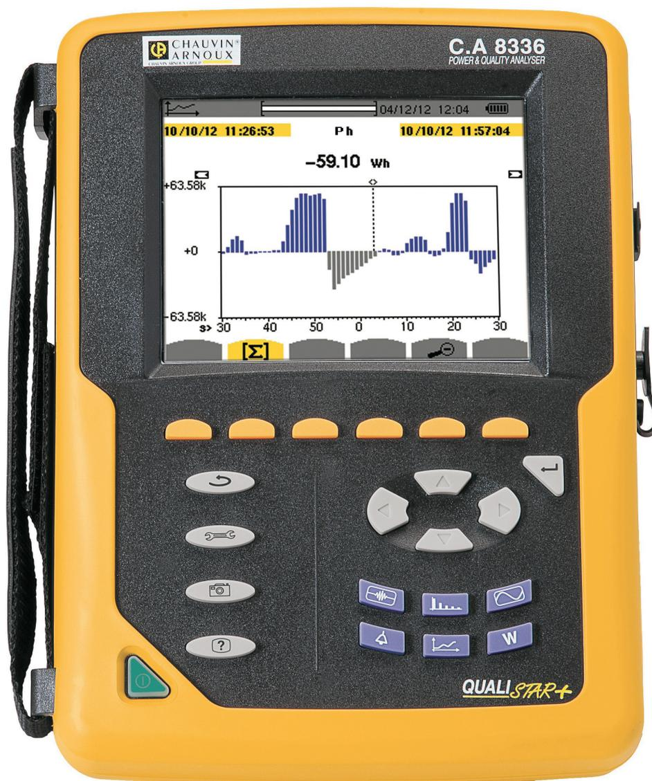
**Analysator für Drehstromnetze**
