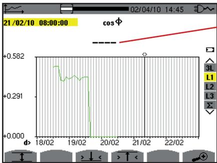
Die Striche bedeuten, dass an der Cursor-Position kein Wert verfügbar ist weil dieser nicht berechnet wurde.
