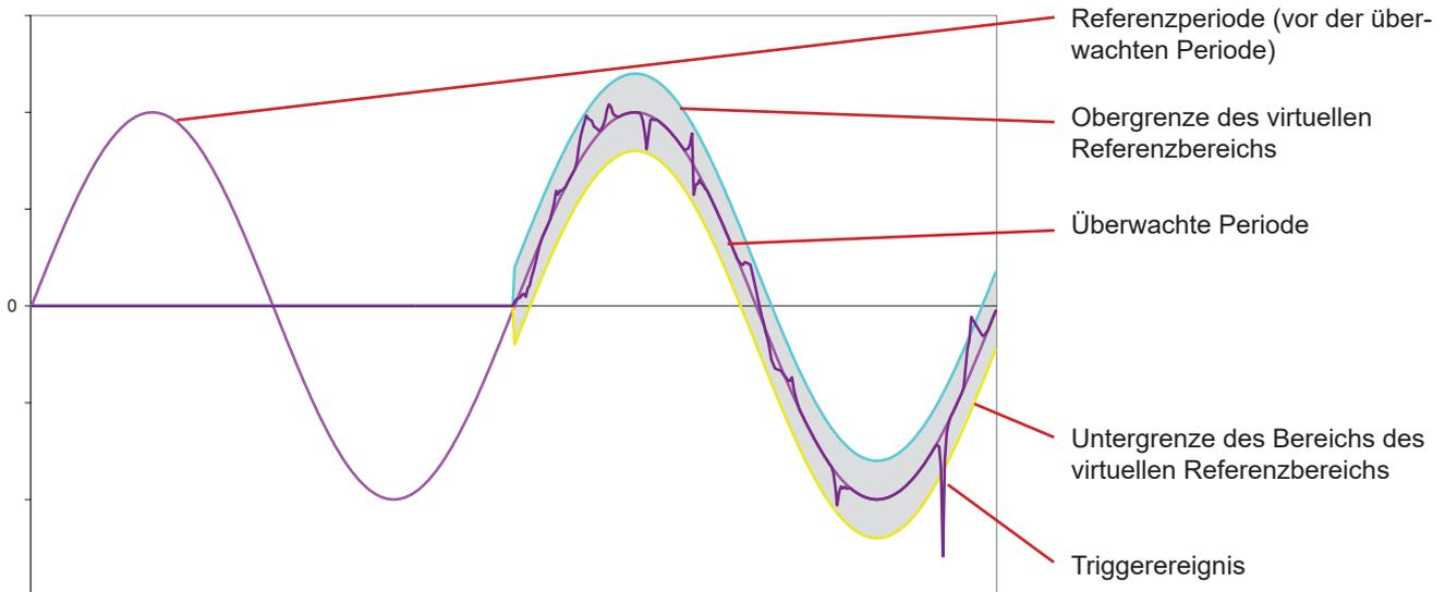
Die virtuelle halbe Breite des Bereichs für die Spannung und den Strom entspricht der im Transienten-Konfigurationsmodus programmierten Schwelle (siehe § 4.8).
