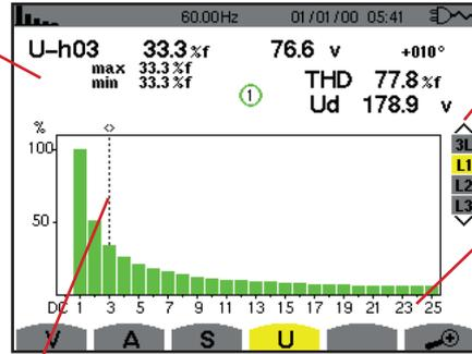
Cursor zur Auswahl der Ordnungen der Oberschwingungen. Verwenden Sie zum Versetzen des Cursors die Tasten  $\leftarrow$  oder  $\rightarrow$ .
