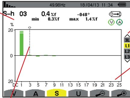
Cursor zur Auswahl der Ordnungen der Oberschwingungen. Verwenden Sie zum Versetzen des Cursors die Tasten ◀ oder ▶.
