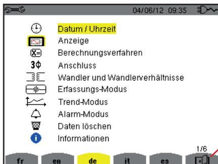
Anschließend drücken Sie die gelbe Gerätetaste, die der gewünschten Sprache entspricht.
