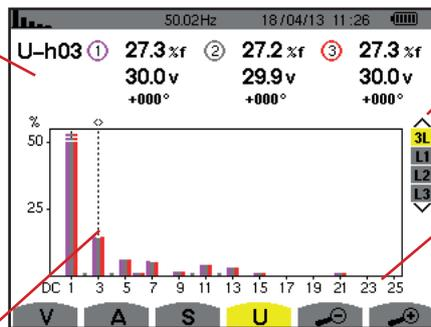
Anzeige der 3 Phasen 3L oder von L1, L2 oder L3. Drücken Sie zur Auswahl der Anzeige die Tasten ▲ oder ▼.
