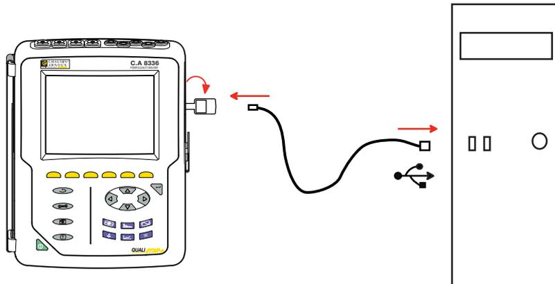
Setzen Sie das Gerät mit der Taste
