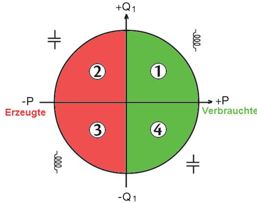
Abbildung 123: 4-Quadranten-Diagramm
