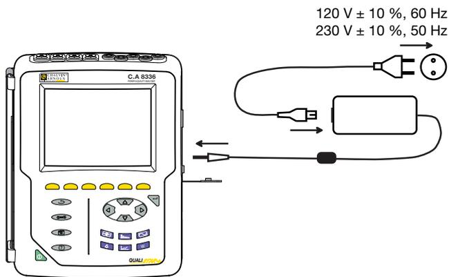
Dazu die Buchsenabdeckung abnehmen und den Stecker des Spezial-Netzteils an das Gerät anschließen. Das Netzkabel an das Netzteil und das Stromnetz anschließen.
