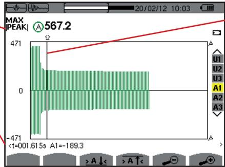
Zeitcursor der Kurve. Verwenden Sie zum Versetzen des Cursors die Tasten ◀ oder ▶.
