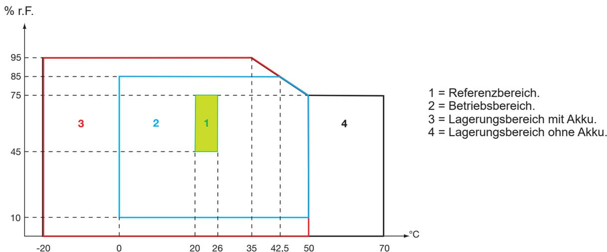
**Achtung:** Bei Temperaturen über 40 °C darf das Gerät entweder „nur mit Akku“ **ODER** „nur mit Netzteil“ betrieben werden. Der Betrieb des Geräts gleichzeitig mit Akku **UND** Spezial-Netzteil ist **verboten**.
