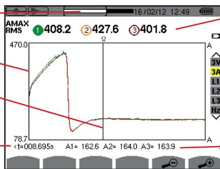
**MAX:** Maximaler RMS-Wert der Halbperiode bei der Anlaufstromerfassung. Nummer der angezeigten Kurve; auf diesem Bild ist der Kreis 1 voll hinterlegt, was bedeutet, dass der Kanal A1 die Anlaufstromerfassung getriggert hat.
