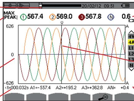
Nummer der angezeigten Kurve; auf diesem Bild ist der Kreis 3 voll hinterlegt, was bedeutet, dass der Kanal A3 die Anlaufstromerfassung getriggert hat.
