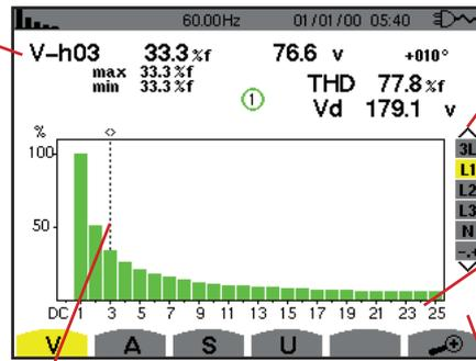
Cursor zur Auswahl der Ordnungen der Oberschwingungen. Verwenden Sie zum Versetzen des Cursors die Tasten  $\leftarrow$  oder  $\rightarrow$ .
