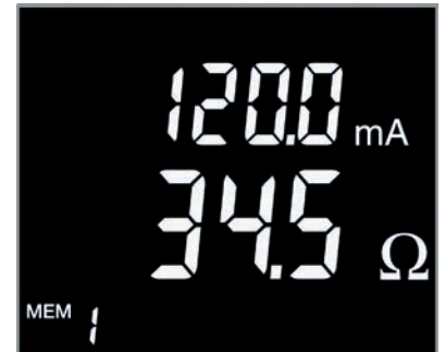
Standardmodus: Impedanz und Fehlerstrom
