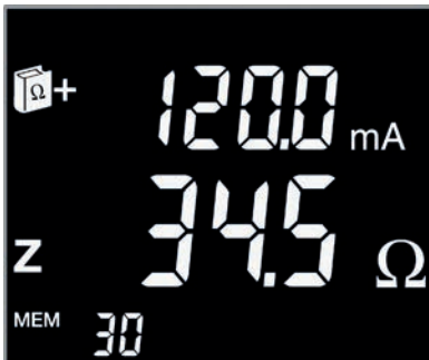
1. Anzeige: Impedanz und Fehlerstrom
