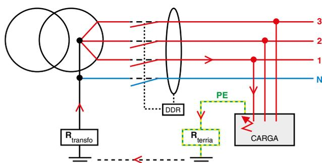
En caso de defecto de aislamiento en la carga, la corriente de defecto se elimina por la tierra a través del conductor de protección (PE). Según su valor, la corriente de defecto ocasiona un corte automático de la instalación al poner en funcionamiento el interruptor diferencial (DDR).
