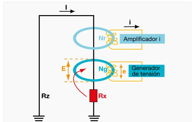
Para identificar correctamente la corriente de medida y evitar las corrientes parásitas, la pinza de tierra utiliza una frecuencia de medida particular.
