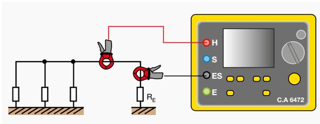
En vez de disponer de una única pinza que incluye el circuito generador y el circuito receptor, se utilizan dos pinzas sirviendo una de generador y la otra de receptor. El interés de disponer de una pinza por función radica en realizar medidas en conductores donde la pinza de tierra no es a veces apropiada a causa de su diámetro para abrazar o de su espesor.
