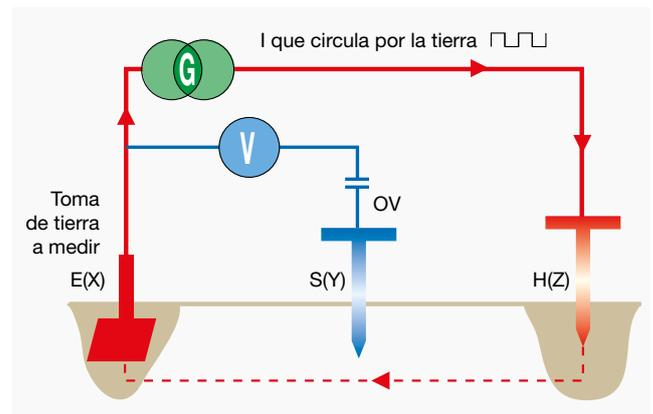
El principio de medida consiste en hacer circular con un generador apropiado **G**, una corriente alterna (*i*) constante a través de la toma auxiliar H llamada "toma de inyección de corriente". Realizándose el retorno por la toma de tierra.
