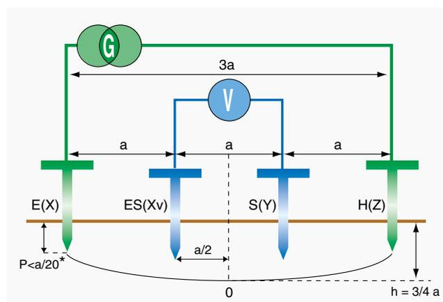
\* Para la auscultación de muy pocas profundidades, la condición de penetración de los electrodos puede incrementarse hasta un 30 % de  $a$ .
