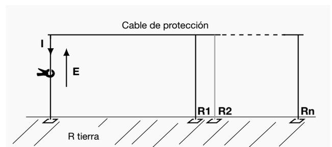
Si se aplica la tensión E en cualquier punto de la puesta a tierra de Rx, una corriente I circula en el bucle según la siguiente ecuación:
