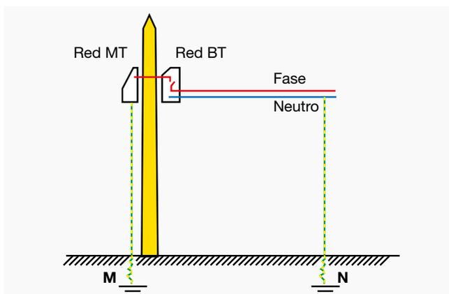
Al caer un rayo en el transformador MT/BT, la elevación de potencial instantáneo puede ser de varios kV.
