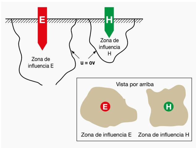
Dada la diferencia de comportamiento de difusión de corriente eléctrica según la resistividad del terreno, difícilmente se puede estar seguro de haber evitado las zonas de influencia. Por lo tanto, la mejor solución para validar la medida consiste en volver a realizar una medida desplazando la pica S y asegurarse de que es del mismo orden de magnitud que la anterior medida.
