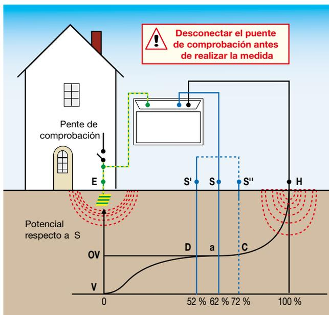
Este método requiere el uso de dos electrodos (o "picas") auxiliares para permitir la inyección de corriente y la referencia de potencial 0 V. La posición de dos electrodos auxiliares, con respecto a la toma de tierra a medir E(X), es determinante. Para realizar una medida correcta, la "toma auxiliar" de referencia de potencial (S) no tiene que estar clavada en las zonas de influencia de las tierras E y H, creadas por la circulación de la corriente (I).
