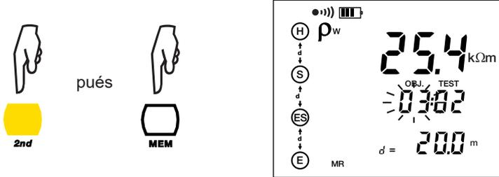
La tecla ▲▼ permite modificar lo que parpadea y la tecla ► permite seleccionar lo que desea cambiar: OBJ, TEST o el tercer criterio de direccionamiento (la distancia en el ejemplo de la izquierda).
