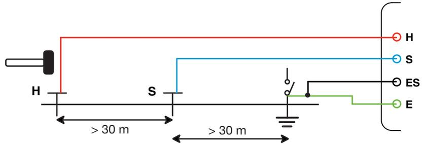
Con el fin de evitar interferencias electromagnéticas, se recomienda devanar el cable del tensor por completo, colocar los cables en el suelo, sin hacer bucles, tan lejos como sea posible unos de otros y evitar la proximidad directa o paralela con conductos metálicos (cables, raíles, valla, etc.). Conecte los cables a los bornes H y S, desconecte el puente de comprobación, luego conecte los bornes E y ES a la toma de tierra a controlar.
