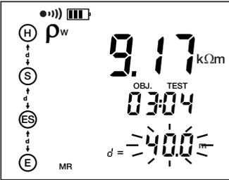
Posteriormente, se pueden sustituir los valores ya memorizados por otros con la misma distancia d o añadir nuevos resultados con otros valores para la distancia d, bajo la condición de que todos los demás parámetros de la medida sean idénticos.
