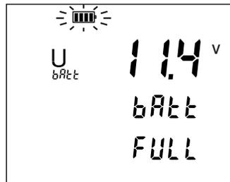
Puede que la batería esté completamente descargada después de un almacenamiento de larga duración. En tal caso, la primera carga puede durar varias horas. Se recomienda efectuar varios ciclos sucesivos de carga y descarga completa (de 3 a 5 ciclos) para que la batería recobre su capacidad inicial.
