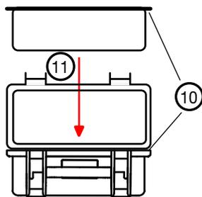
11. Coloque el cuerpo del instrumento en la carcasa, cierre la tapa y apriete los tornillos de fijación.
