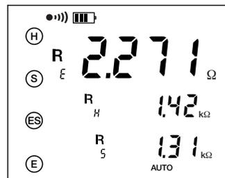
Se recomienda repetir la medida con picas auxiliares clavadas a una distancia distinta y orientadas hacia otra dirección (véase § 3.2.1).
