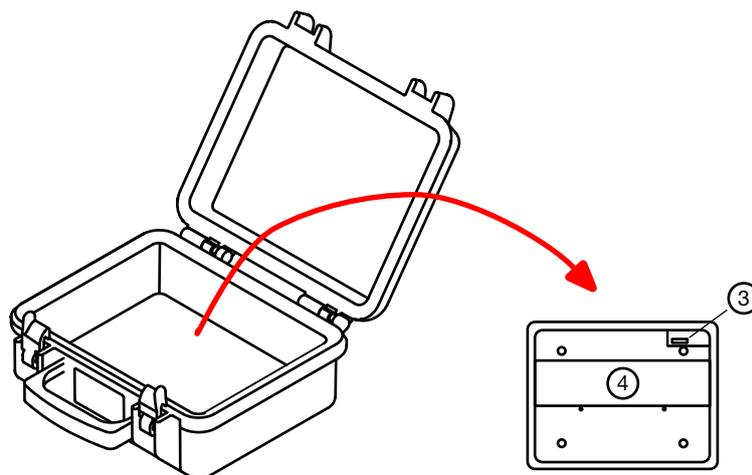
4. Si sólo tiene que reemplazar el fusible del borne H, remítase directamente al punto 9 más abajo. Si también desea sustituir el fusible de la entrada de la pinza ES, desatornille los dos tornillos de la tapa de la batería y quítela.
