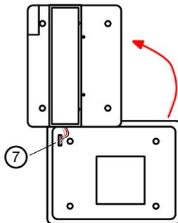
7. Desenchufe el conector 4 puntos de la batería separando ligeramente la lengüeta. Procure no tocar con las manos el circuito y sus componentes.
