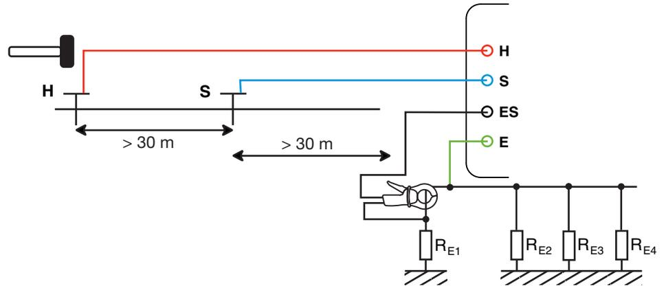
Con el fin de evitar interferencias electromagnéticas, se recomienda devanar el cable del tensor por completo, colocar los cables en el suelo, sin hacer bucles, tan lejos como sea posible unos de otros y evitar la proximidad directa o paralela con conductos metálicos (cables, raíles, valla, etc.).
