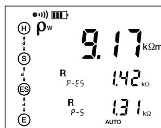
Los elementos metálicos situados en el terreno (raíles de ferrocarril, canalizaciones, etc.) o las venas de agua subterráneas pueden influir sobre la resistividad del terreno en una dirección dada. Se aconseja entonces realizar otra medida, disponiendo las picas a 90° respecto de la primera medida, para revelar eventuales efectos directivos. Por otro lado, se recomienda realizar varias medidas con distintas distancias  $d$  para eliminar los efectos locales que puedan falsear la medida.
