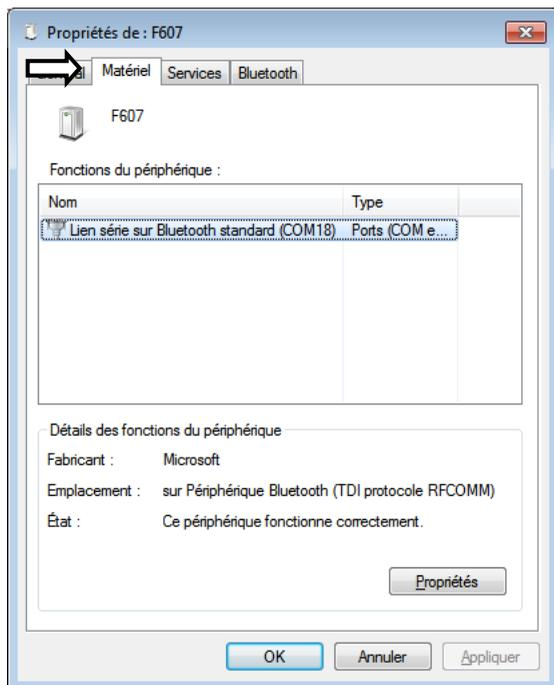
2.3 Connexion del instrumento en curso con el software PAT, mediante Bluetooth. Sólo se debe seleccionar "Puerto COM" para comunicarse, seleccione el puerto COM correcto (aquí COM18).
