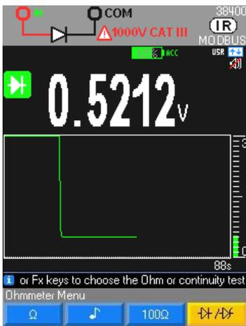
Lectura del valor de tensión de umbral, aparece O.L si el circuito está abierto o si el umbral del diodo es >4 V.
