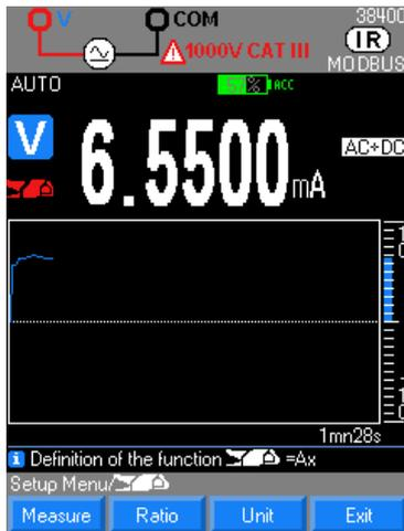
1. Active la función pinza y, según el tipo de pinza conectada, pulse dos veces "Pinza" o vaya al menú setup/pinza y definir el acoplamiento.
