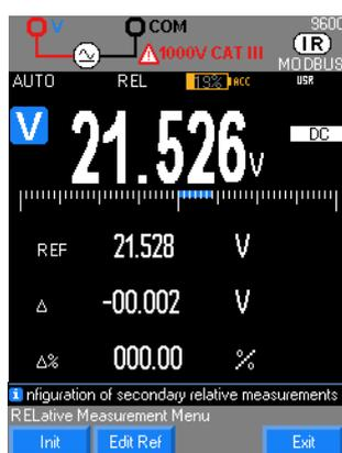
En modo continuo "DC", Usted mide el valor de una tensión continua o la componente continua de una tensión alterna.
