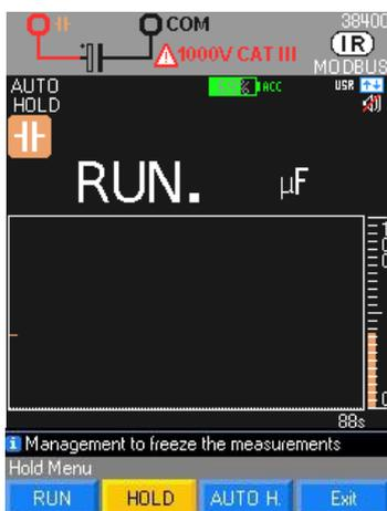
Medida de la capacidad de un condensador con una resolución de 1.000 pts "Run" aparece cuando la se está realizando la medida.
