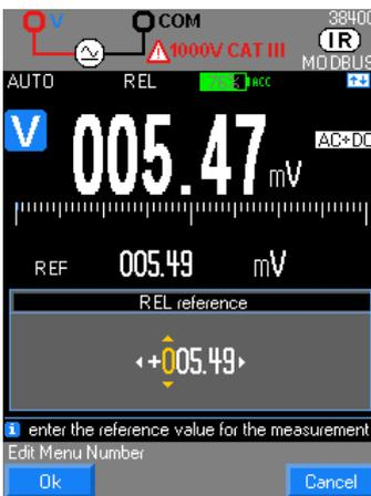
Este modo indica que el valor visualizado se refiere a un valor de referencia. Se puede acceder a este modo para las siguientes funciones de medida: V, Hz, Ohm, pinza, capacidad, temperatura y corriente.
