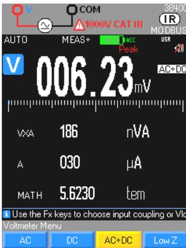
El cálculo de la potencia **VxA** (VA) requiere una tercera conexión a la entrada A (conectada al mismo circuito), para medir simultáneamente:
