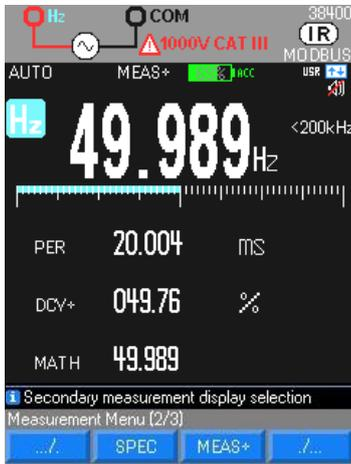
Visualización de la medida en % de una señal lógica (TTL, CMOS...)
