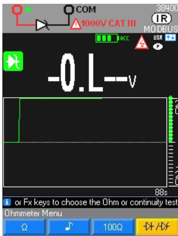
Diodo Zener o LED, la selección de este diodo es una función idéntica al diodo más arriba pero con una tensión máxima de 26 V y una corriente máxima de 10 mA.
