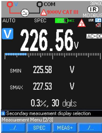
A partir de las especificaciones técnicas internas al multímetro, el modo **SPEC** indica directamente la tolerancia de la medida en curso, sin que se tenga que buscar y calcular. Este modo es muy útil para la metrología del instrumento.
