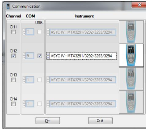
Con ciertos adaptadores Bluetooth, se recomienda reiniciar el PC para validar la conexión. Los parámetros de conexión son exclusivos a cada multímetro. Deben asignarse manualmente, únicamente la primera vez.
