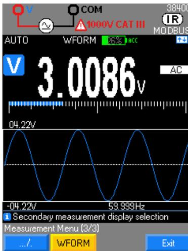
Durante la medida de tensión AC, se puede ver la forma de onda de las señales de frecuencia 10 Hz a 600 Hz con la función **wFORM**.
