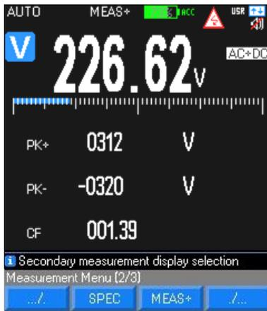
El rango 100 mV está presente únicamente en modo MANUAL, con **Range**. En todos los casos, "O.L." aparece por encima de 1.050 V y una señal acústica suena cuando la medida supera 600 V. El símbolo de tensión peligrosa aparece cuando "V" supera 60 VDC o 25 VAC
