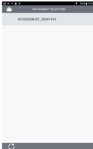
Activar la funcionalidad Bluetooth y el protocolo MODBUS en el multímetro. La conexión se inicia pulsando el nombre del instrumento cuando aparezca.
