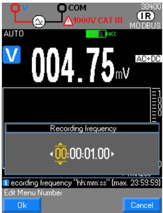
La validación de la **Frec.** con la tecla [F3] abre un menú de ajuste de la frecuencia de registro deseada en cuanto a hora, minuto y segundo.
