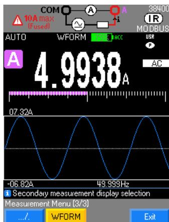
Durante la medida de corriente AC, se puede ver la forma de onda de las señales de frecuencia 10 Hz a 600 Hz con la función **wFORM**.
