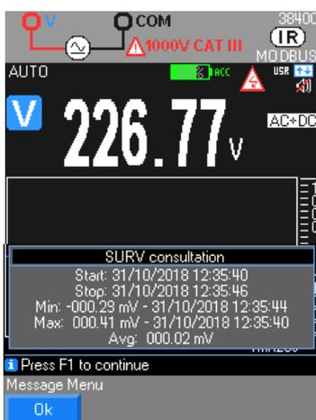
1. Pulse la función V, luego seleccione el acoplamiento según sus medidas: AC, DC, AC+DC, LowZ (AC por defecto).
