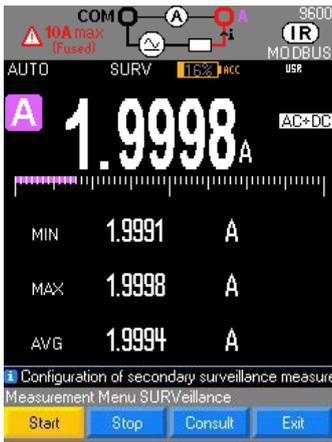
1. Pulse la función A, luego seleccione el acoplamiento según sus medidas: AC, DC, AC+DC, (AC+DC por defecto).
