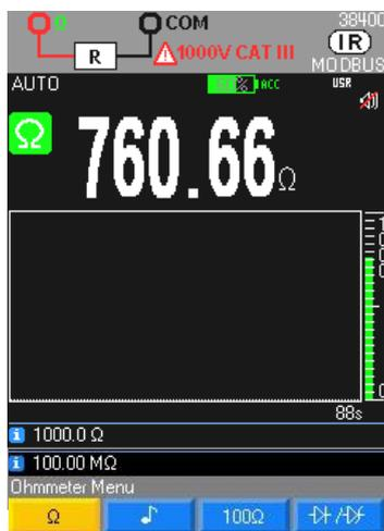
En el rango 50 M $\Omega$ , para evitar la influencia de la red y garantizar las especificaciones indicadas, se recomienda desconectar el multímetro del Wall Plug para evitar las perturbaciones.
