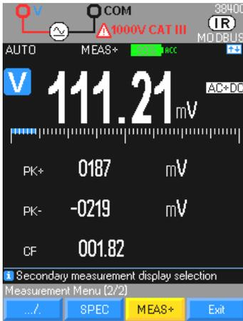
Se puede acceder a las medidas de peak rápidas en las medidas secundarias **MEAS**, **MEAS+**, **PK+** y **PK-** para las siguientes funciones de medida: V y A (AC, AC+DC); tiempo de integración a **250 µs**.
