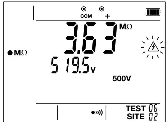
Cuando suelte el botón **TEST**, el instrumento mostrará **dis** (= discharge = descarga) para indicar que descarga el dispositivo probado. Si el dispositivo no es capacitivo, la descarga es muy rápida. Cuando la tensión esté por debajo de 25 V, desaparecerán los símbolos **dis** y
