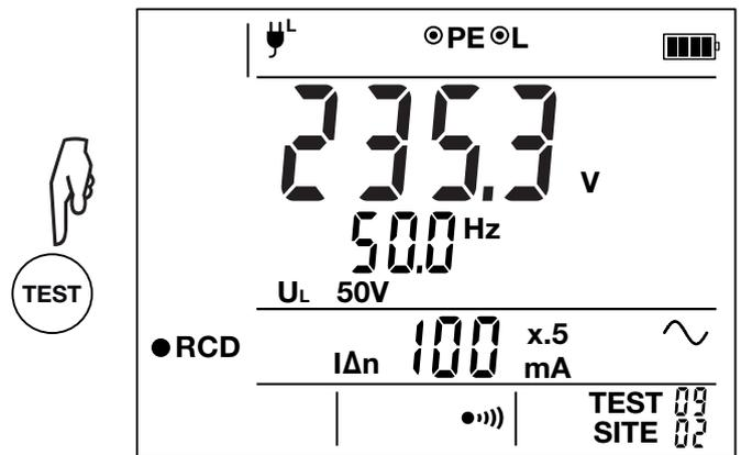
Pulse de nuevo la tecla **TEST** para volver a la medida de tensión.
