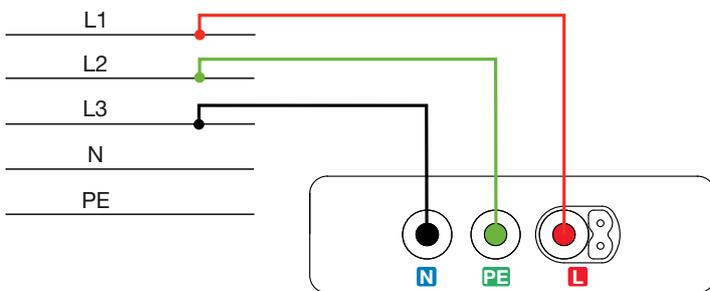
Las tensiones compuestas aparecerán, cada uno de los valores  $U_{12}$ ,  $U_{23}$  y  $U_{32}$  alternativamente, así como el sentido de rotación de fase  $\overset{L1}{\curvearrowright} \overset{L3}{\curvearrowleft} \overset{L2}{\curvearrowright}$  o  $\overset{L1}{\curvearrowleft} \overset{L3}{\curvearrowright} \overset{L2}{\curvearrowleft}$ .
