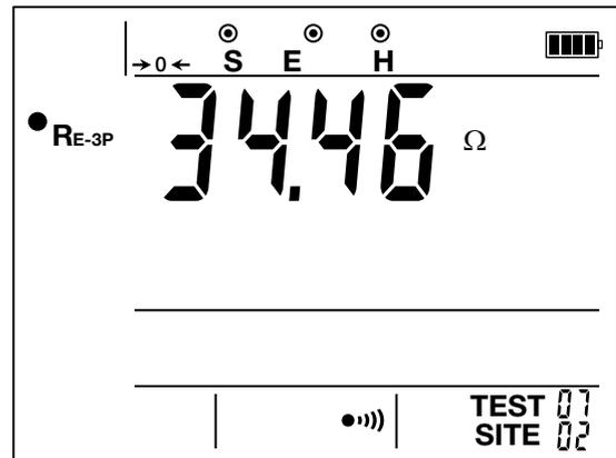
⚠ Una vez la medida finalizada, no olvide volver a conectar el puente de comprobación antes de volver a encender la instalación.
