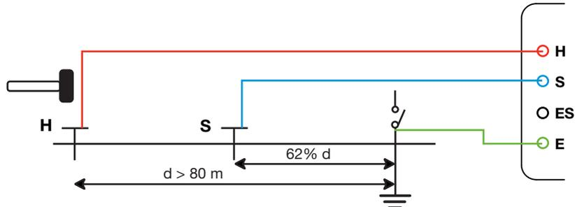
Con el fin de evitar interferencias electromagnéticas, se recomienda devanar el cable del tensor por completo, colocar los cables en el suelo, sin hacer bucles, tan lejos como sea posible unos de otros y evitar la proximidad directa o paralela con conductos metálicos (cables, raíles, valla, etc.). Conecte los cables a los bornes H y S, desconecte el puente de comprobación, luego conecte el borne E a la toma de tierra a controlar.
