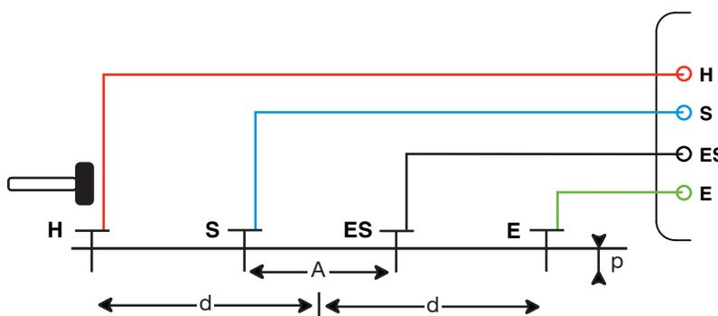
Con el fin de evitar interferencias electromagnéticas, se recomienda devanar el cable del tensor por completo, colocar los cables en el terreno, sin hacer bucles, tan lejos como sea posible unos de otros y evitar la proximidad directa o paralela con conductos metálicos (cables, raíles, valla, etc.).
