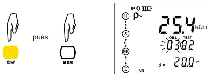
La tecla ▲▼ permite modificar lo que parpadea y la tecla ► permite seleccionar lo que desea cambiar: OBJ, TEST o el tercer criterio de direccionamiento (la distancia en el ejemplo de la izquierda).
