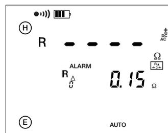
Se pierde el valor de la compensación de los cables de medida en cuanto se gira el conmutador.
