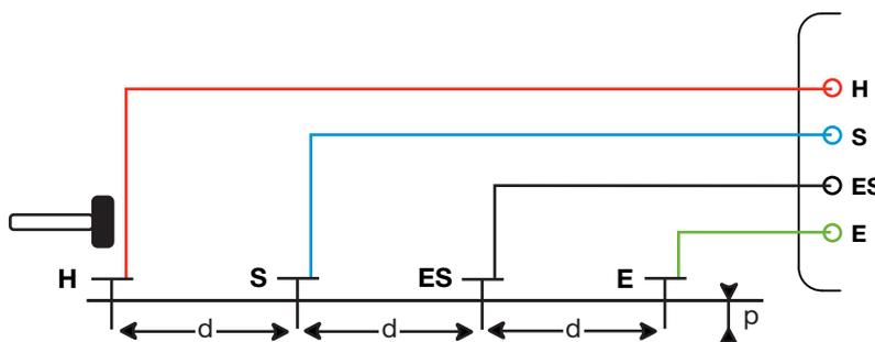
Con el fin de evitar interferencias electromagnéticas, se recomienda devanar el cable del tensor por completo, colocar los cables en el suelo, sin hacer bucles, tan lejos como sea posible unos de otros y evitar la proximidad directa o paralela con conductos metálicos (cables, raíles, valla, etc.).
