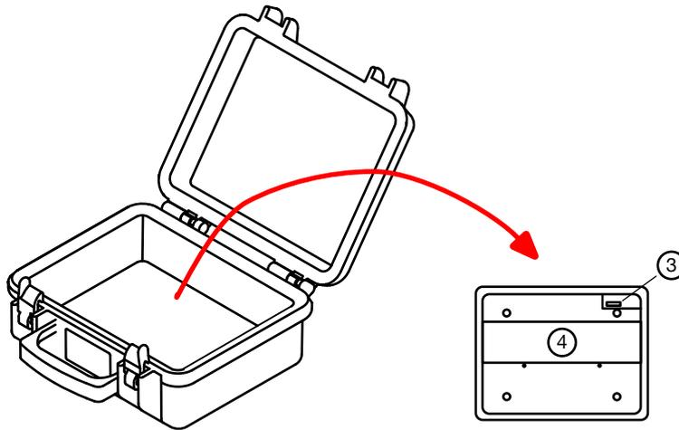
4. Vuelva a colocar la tapa de la batería en su sitio y apriete los tornillos.
