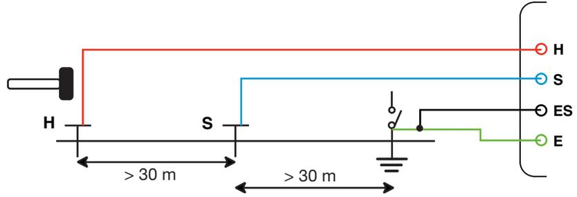
Con el fin de evitar interferencias electromagnéticas, se recomienda devanar el cable del tensor por completo, colocar los cables en el suelo, sin hacer bucles, tan lejos como sea posible unos de otros y evitar la proximidad directa o paralela con conductos metálicos (cables, raíles, valla, etc.). Conecte los cables a los bornes H y S, desconecte el puente de comprobación, luego conecte los bornes E y ES a la toma de tierra a controlar.
