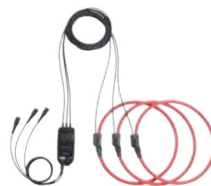
La longitud de los sensores de esta serie, de hasta 120 cm en estándar, permite abrazar cables gruesos o varios conductores simultáneamente. Los **A110** permiten medidas de corriente de hasta 30 kA<sub>CA</sub>.
