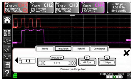
In normal «Oscilloscope» display mode, select to trigger on the AUX signal pulse width («Trigger» menu → «Pulse» tab).
