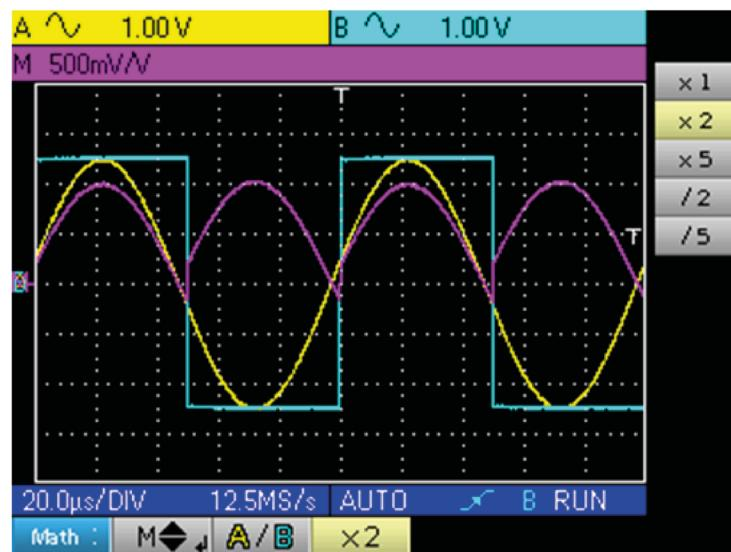
La sensibilidad de la vía M pasa a 500 mV/V y la amplitud máxima positiva de la traza es de 1 V/V.
