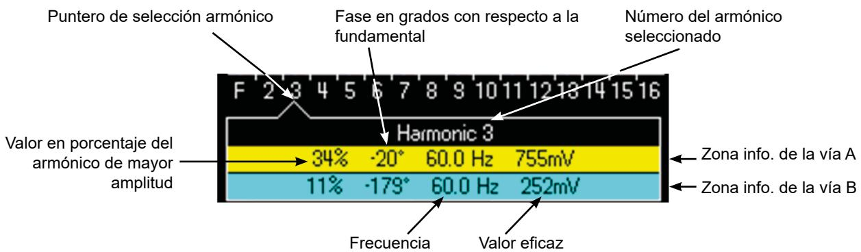
Esta ventana muestra las mediciones específicas del armónico seleccionado para cada vía.
