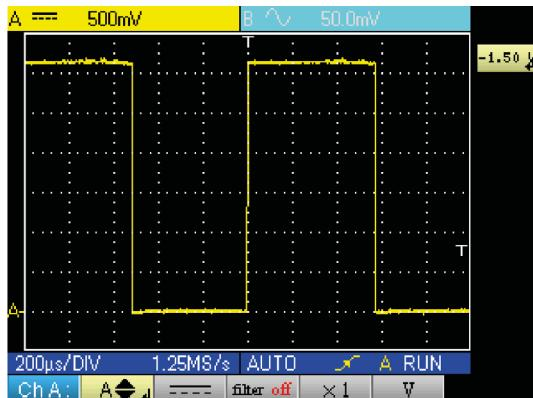
Gire el tornillo en uno u otro sentido, de modo que la señal quede horizontal y se parezca a la de pantalla que figura a la izquierda. Ahora la sonda está calibrada y se puede girar de nuevo la base del BNC de la sonda para cerrar el acceso al ajuste.
