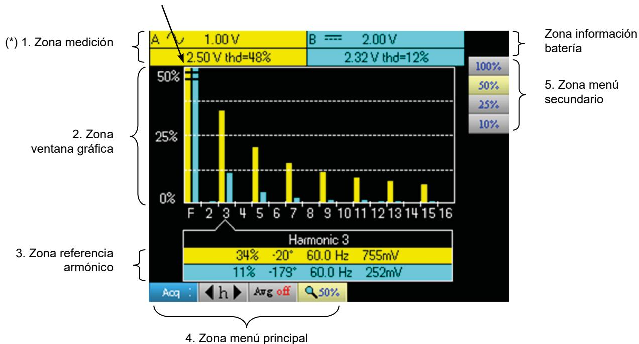
(\*) Si no se selecciona ninguna medición o si la vía no está validada, la medición será sustituida por una línea de puntos.
