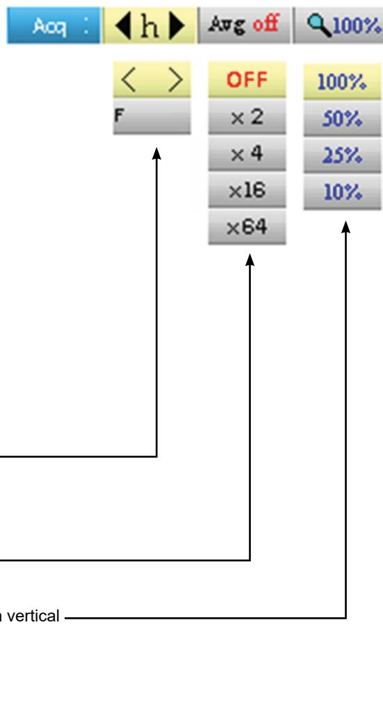
El usuario puede modificar la escala vertical de la zona de visualización de los armónicos lo cual permite ver con mayor facilidad los armónicos que han tenido poca amplitud con respecto a la fundamental.
