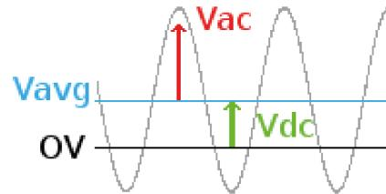
donde:  $V_{AC+DC} = \sqrt{V_{AC}^2 + V_{DC}^2}$
