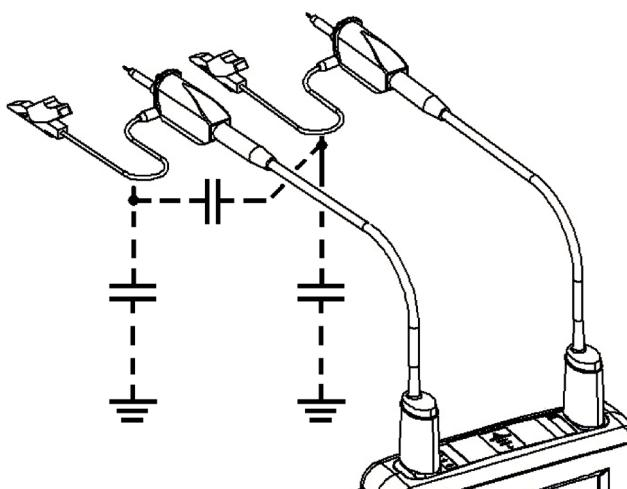
Habida cuenta de las capacidades parásitas, es imprescindible conectar correctamente los conductores de referencia de cada sonda. De preferencia, estos conductores deben estar conectados a los puntos fríos para evitar la transmisión de ruidos por la capacidad parásita entre modos.
