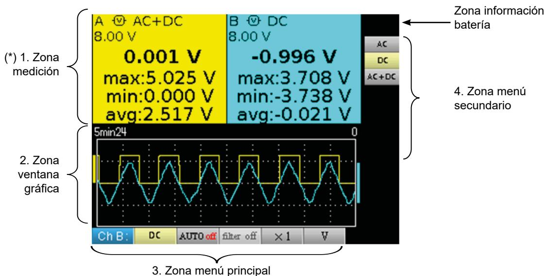
(\*) Si la medición no es posible, la visualización se hará en forma de línea de puntos. Si la vía no está validada, la medición será sustituida por "-x-".
