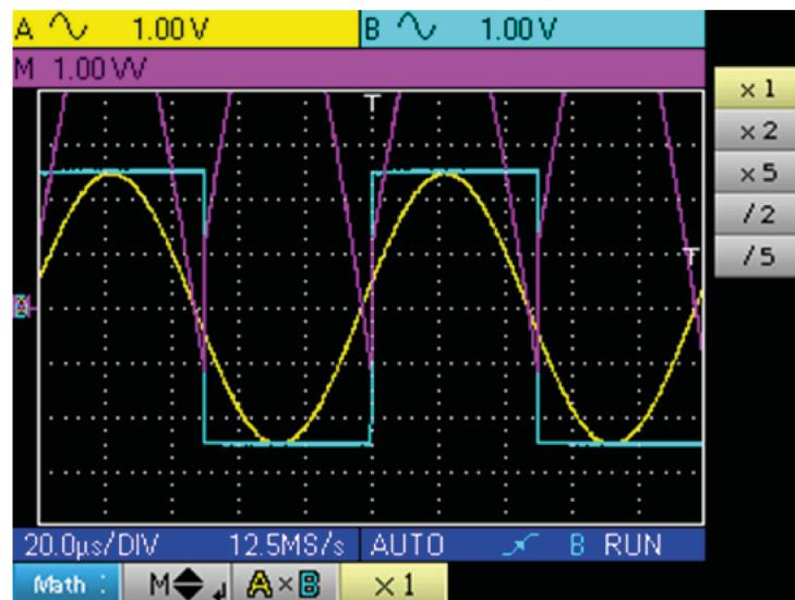
En nuestro ejemplo, la amplitud pico de nuestra función matemática es de  $2,5 \text{ V} * 2,5 \text{ V} = 6,25 \text{ VV}$ ; como la sensibilidad de la vía M es de 1 VV (con el coeficiente x 1), se observa un rebasamiento de la traza que se puede corregir utilizando el coeficiente /2.
