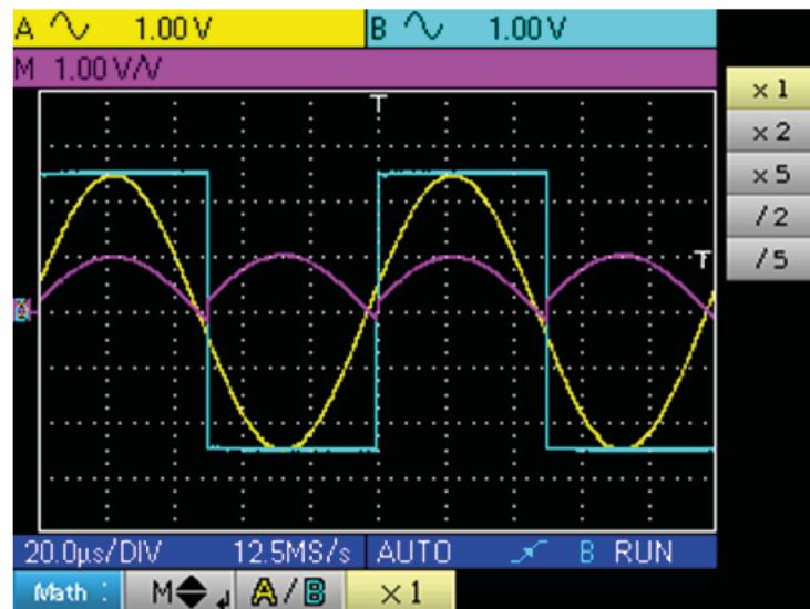
Dado que las tensiones máximas positivas de las señales A y B son iguales, la división conlleva una tensión máxima positiva de 1 V/V y, por lo tanto, una representación de 1 división en la traza, que podemos dilatar escogiendo el coeficiente x 2 o x 5 :
