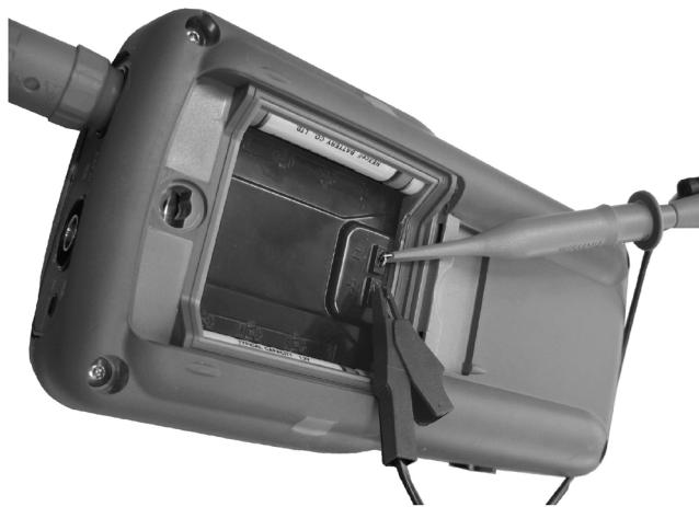
Conecte la sonda que se vaya a ajustar a la salida de la calibración situada detrás de este compartimento, como se indica en la figura de la izquierda.
