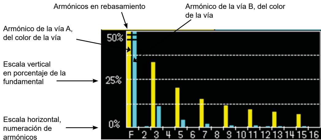
Esta zona muestra los armónicos de 1 a 16 de las vías confirmadas en forma de histograma. El usuario puede comutar la visualización de los armónicos 2 a 16 con la visualización de los armónicos 17 a 31. El máximo de la escala vertical dependerá del coeficiente de zoom. Este coeficiente de zoom se puede modificar desde el menú de Adquisición.
