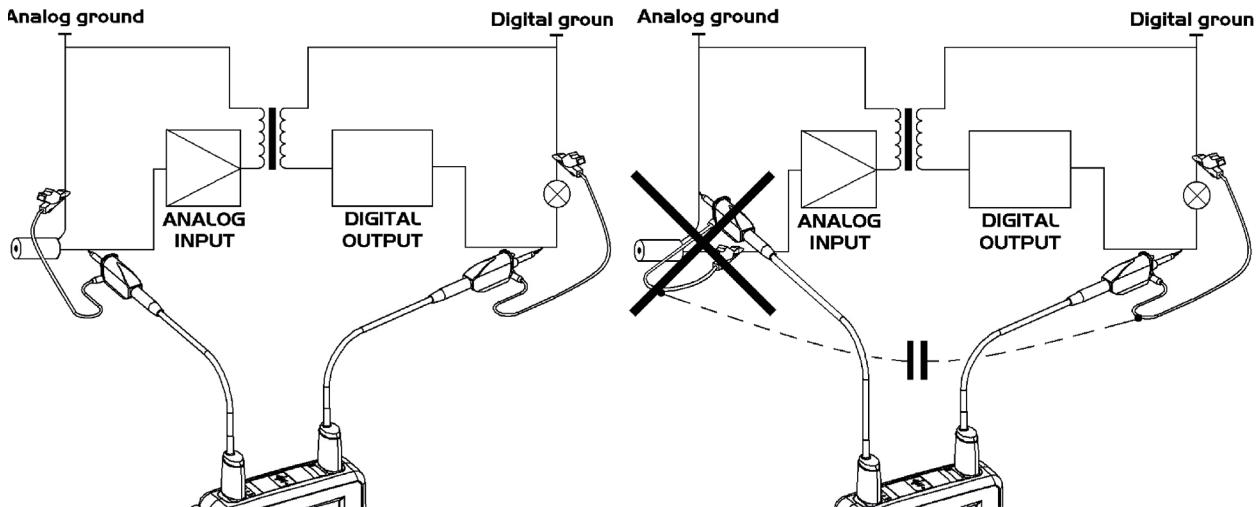
El ruido de la masa digital es transmitido a la entrada analógica por la capacidad parásita.
