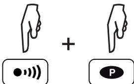
Pulse simultáneamente las teclas **•)))** y **P** (para el C.A 6131) o **•)))** y **MEM** (para el C.A 6133).
