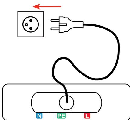
Aparecerá la medida. El instrumento indicará que realiza la medida entre los bornes L y N. Por lo tanto, se pueden utilizar dos cables para realizar la medida. Sólo el C.A 6133 indicará la frecuencia.
