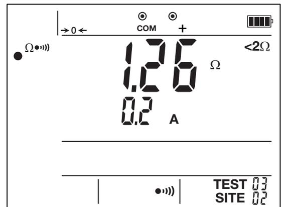
Mientras la medida varíe entre un valor y **OL**, el instrumento no se apagará, sin tener que utilizar el modo permanente **P**.
