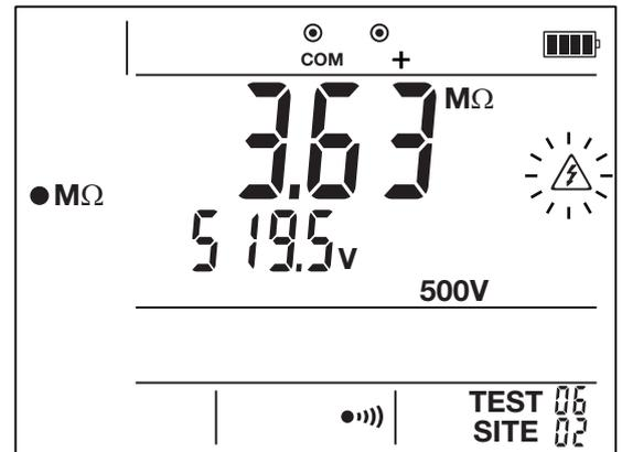
Cuando suelte el botón **TEST**, el instrumento mostrará **dis** (= discharge = descarga) para indicar que descarga el dispositivo probado. Si el dispositivo no es capacitivo, la descarga es muy rápida. Cuando la tensión esté por debajo de 25 V, desaparecerán los símbolos **dis** y ⚠ del display.
