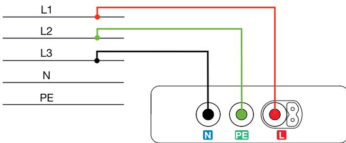
Las tensiones compuestas aparecerán, cada uno de los valores  $U_{12}$ ,  $U_{23}$  y  $U_{32}$  alternativamente, así como el sentido de rotación de fase  $\overset{L1}{\curvearrowright} \overset{L3}{L2}$  o  $\overset{L3}{\curvearrowright} \overset{L1}{L2}$ .
