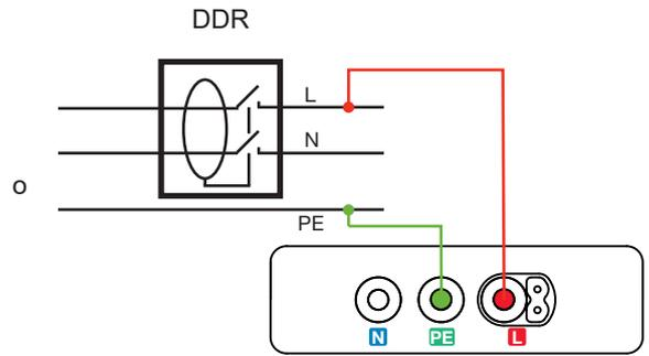
El instrumento comprueba primero que la tensión entre los bornes **L** y **PE** es correcta. En tal caso, aparecerá el símbolo y se quedará fijo. En caso contrario, el símbolo parpadeará y no se podrá realizar la prueba. Si  $U_{LPE} < 90 \text{ V}$ , el instrumento mostrará alternativamente  $U_{LPE}$  y  $U_{NPE}$ .
