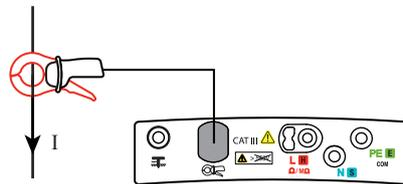
La medida de corriente puede efectuarse en diferentes conductores de una instalación. Es por eso que es posible indizar el valor registrado con uno de los siguientes valores:
