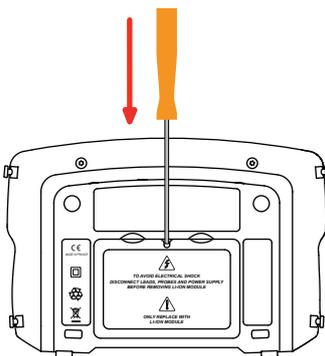
2. Dé la vuelta al instrumento e introduzca un destornillador en el agujero del pack de batería.
