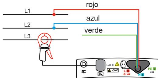
La medida de potencia puede efectuarse en diferentes fases de una instalación. Es por eso que es posible indizar el valor de la potencia registrado con uno de los siguientes valores: 1, 2 ó 3 (medidas monofásicas en una red trifásica).
