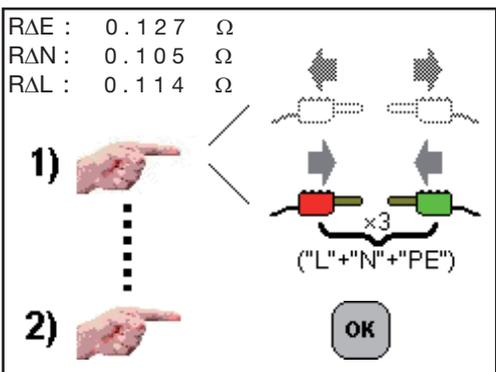
Conecte los tres cables que va a utilizar para la medida a los terminales L, N y PE, cortocircuitelos y pulse el botón **TEST**.
