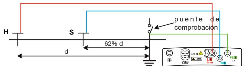
Conecte los cables a los terminales H y S. Ponga la instalación fuera de tensión y desconecte el puente de comprobación. A continuación, conecte el terminal E a la toma de tierra que se va a controlar.
