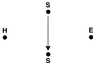
Procure que no pasen los cables de conexión de las picas de tierra a proximidad directa de o en paralelo a otros cables (de transmisión o de alimentación), conductos metálicos, raíles o vallas, para evitar los riesgos de diafonía con la corriente de medida.
