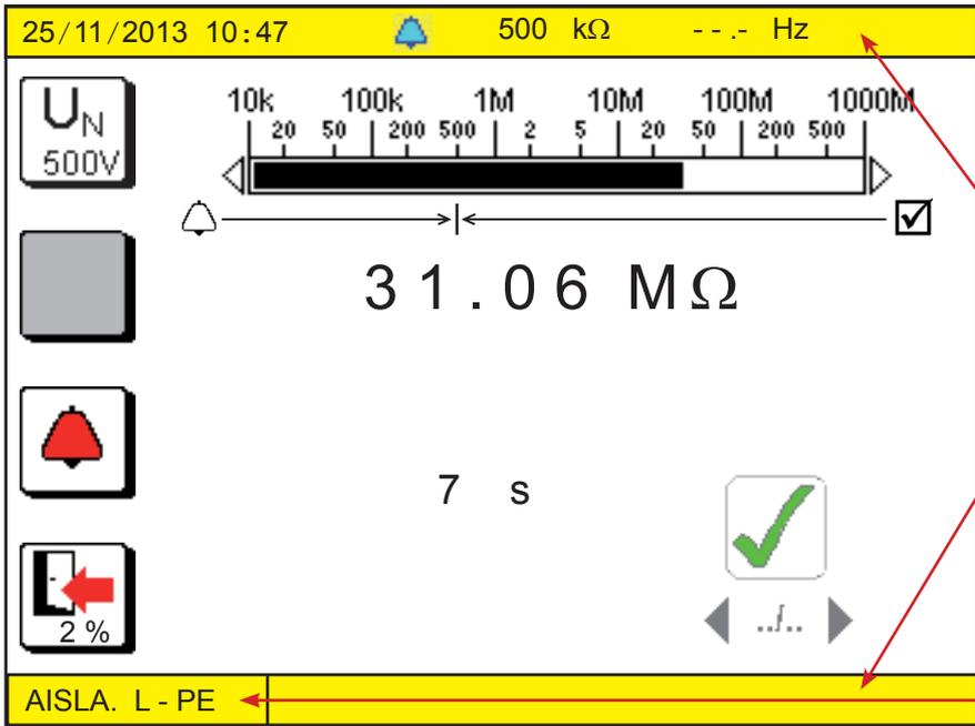
La visualización de las bandas inferior y superior del display se efectúa en vídeo invertido para diferenciar correctamente una medida que se acaba de realizar de una lectura de la memoria.
