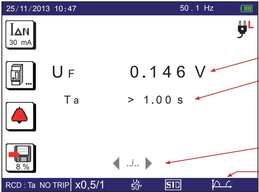
$$U_F = Z_S \times I_A \text{ o } R_A \times I_A.$$
