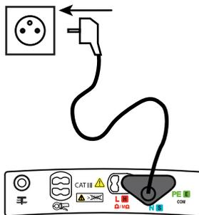
Para las posiciones  $Z_s$  (RA/SEL.) y RCD, el instrumento indica también la posición de la fase en el display con el símbolo . La toma de red del cable tripolar está señalada con un punto blanco.
