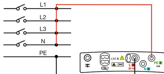
Si el aislamiento no es suficiente, se tiene que efectuar la medida entre cada uno de los pares para localizar el fallo. Es por eso que es posible indizar el valor registrado con uno de los siguientes valores: L-N, L-PE, N-PE, L1-PE, L2-PE, L3-PE, L1-N, L2-N, L3-N, L1-L2, L2-L3 o L1-L3
