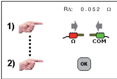
Conecte los dos cables que va a utilizar para las medidas a los terminales  $\Omega$  y COM, cortocircuitelos y pulse el botón **TEST**.
