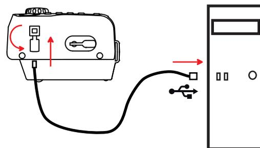
A continuación, encienda el instrumento girando el conmutador hasta cualquier posición.
