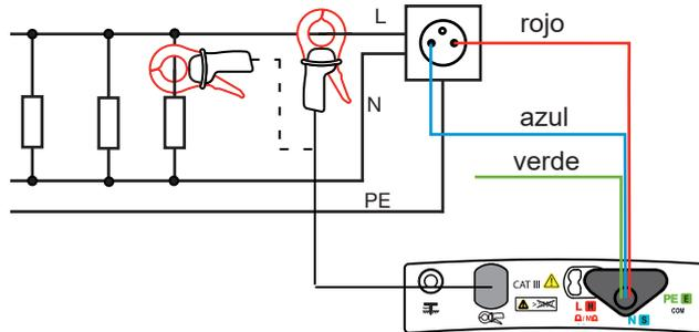
En el caso de una red trifásica equilibrada en tensión y corriente, conecte el cable tripolar acabado por 3 cables en un extremo al instrumento y el otro extremo a dos de las tres tensiones  $U_{12}$ ,  $U_{23}$  o  $U_{31}$  mediante los cables rojo y azul. A continuación con la pinza abra el conductor de la tercera fase  $I_3$  (para  $U_{12}$ ),  $I_1$  (para  $U_{23}$ ) o  $I_2$  (para  $U_{31}$ ).
