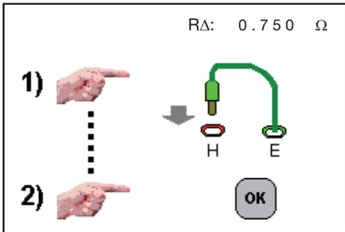
Conecte el cable que va a utilizar para conectar el terminal E a la tierra entre los terminales H y E y pulse el botón **TEST**.
