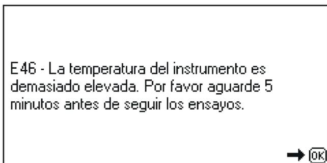
La temperatura interna del instrumento es demasiado alta. Espere a que el instrumento se enfríe antes de volver a realizar una medida. Este caso concierne principalmente la prueba de los diferenciales.
