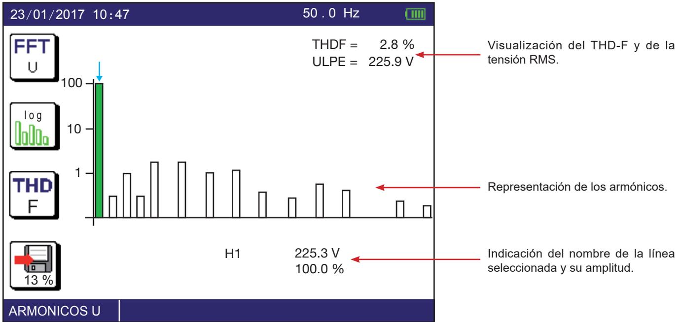
La frecuencia y la amplitud del armónico seleccionado (en verde) están indicadas abajo del gráfico. Para seleccionar otro armónico, utilice las teclas ◀ ▶. El instrumento pasa entonces de la fundamental (H1) al armónico H2, y luego a los armónicos (H3, H4, ..., H25). Y en la siguiente página, barre los armónicos H26 a H50.
