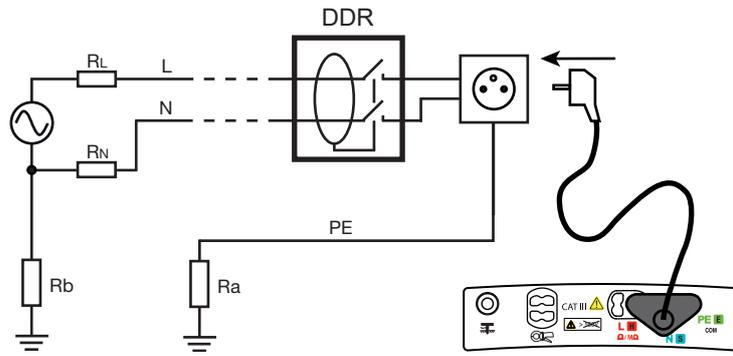
**i** En la medida de lo posible, desconecte previamente todas las cargas de la red en la cual usted efectúa la prueba del diferencial. Esto permite no perturbar la prueba con posibles corrientes de fuga debidas a estas cargas.
