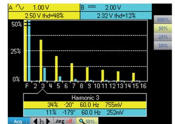
Die **Bildschirmdarstellung wird automatisch durch Ausblenden der Menüs optimiert, wenn der Bediener 20 s lang nichts unternimmt. Am Bildschirm gehen dadurch keine Daten verloren, das Signal wird über die gesamte Bildschirmbreite dargestellt.**
