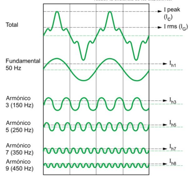
La distorsión de la forma de onda se puede analizar matemáticamente para mostrar que generalmente es equivalente a superponer componentes de frecuencia adicionales en la onda sinusoidal original de 50 Hz. Estas frecuencias son armónicos de la frecuencia fundamental y, a veces, pueden propagarse hacia el exterior desde las cargas no lineales y causar problemas en otras partes de la instalación eléctrica.
