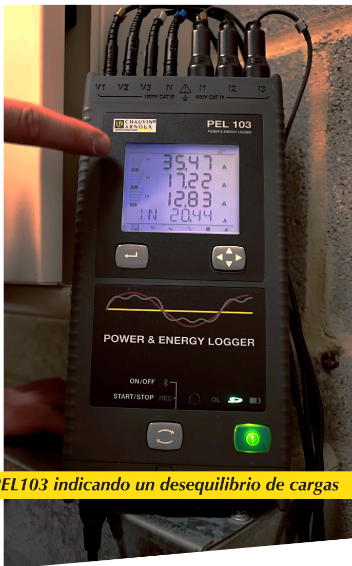
El PEL103 indicando un desequilibrio de tensión entre fases
