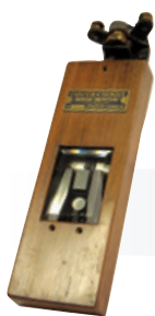
Galvanómetro de reflexión de 1895
