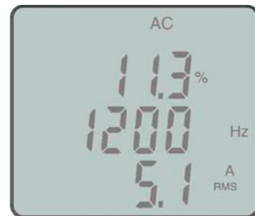
Pantalla F407 Medida de armónicos H3 de una fundamental a 400 Hz
