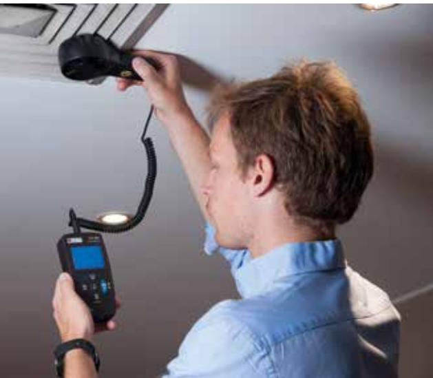
Ejemplo de medida con un termoanemómetro CA 1227
