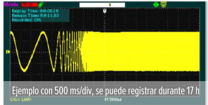
En el caso del **modo registrador**, no se puede ampliar después de la adquisición, los segmentos tienen una profundidad constante de 2.500 cuentas y para cada trama todos los puntos se representan en pantalla, es decir  $2.500/18=138$  cuentas por división.
