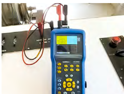
Aquí, el canal 1 del Handscope está conectado al inductor mediante el adaptador BNC/Banana.
