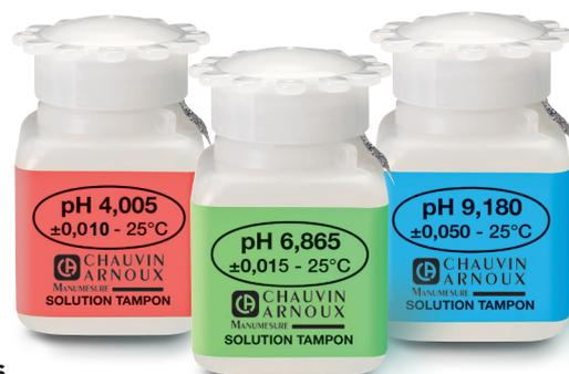
Pour répondre à vos besoins, MANUMESURE lance une gamme de **solutions d'étalonnage** aux valeurs **pH de 4,005 ± 0,010 ; 6,865 ± 0,015 et 9,180 ± 0,050** traçables aux étalons internationaux en flacon unidose de 25 ml.
